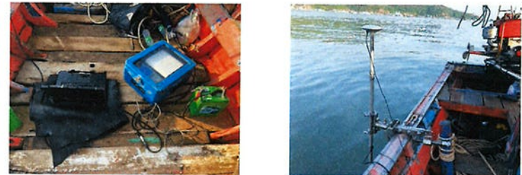
ภาพที่ 13 ติดตั้งอุปกรณ์สำรวจในเรือสำรวจ
