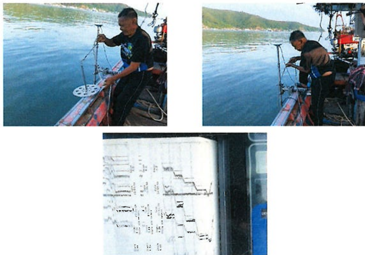
ภาพที่ 14 ตรวจสอบความถูกต้องของเครื่องหยั่งน้ำ
