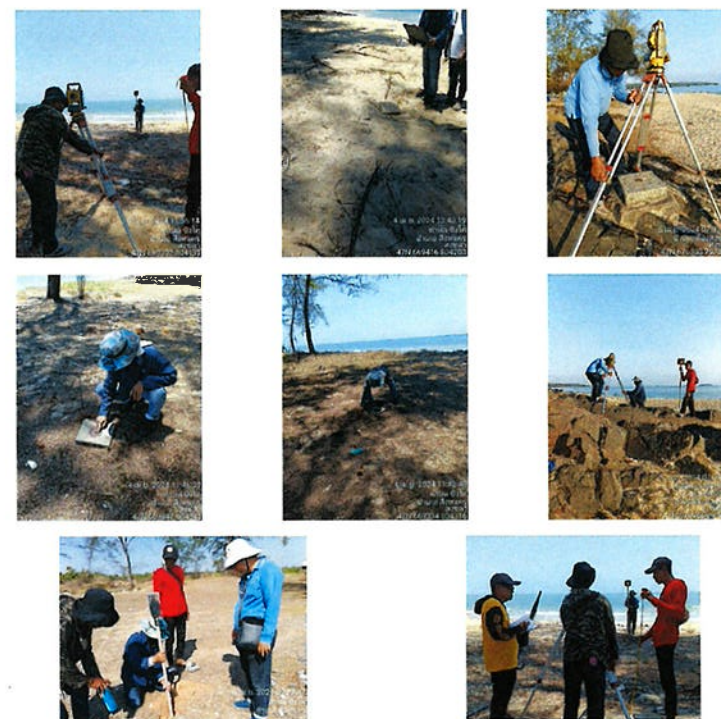
ภาพที่ 1 งานตรวจสอบหมุดหลักฐาน และหมุดอ้างอิงแนวชายฝั่ง
